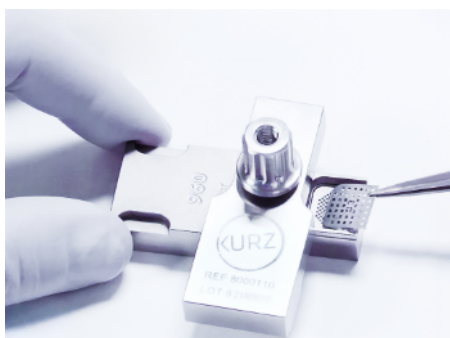
Ilustrație 3: Grosimea grefelor de cartilaj = 0,7 mm minus grosimea plăcilor de distanțiere
